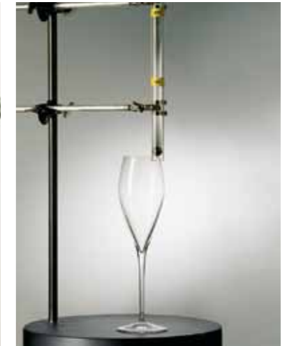
Prova resistenza bordo
