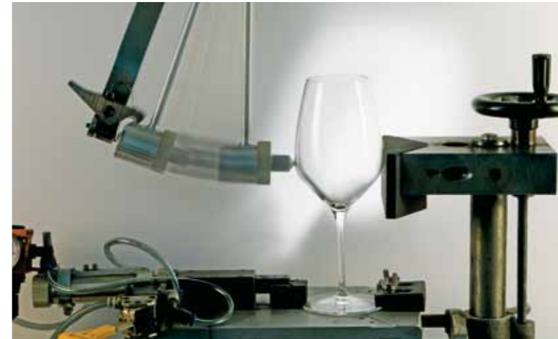
Prova resistenza urto coppa
